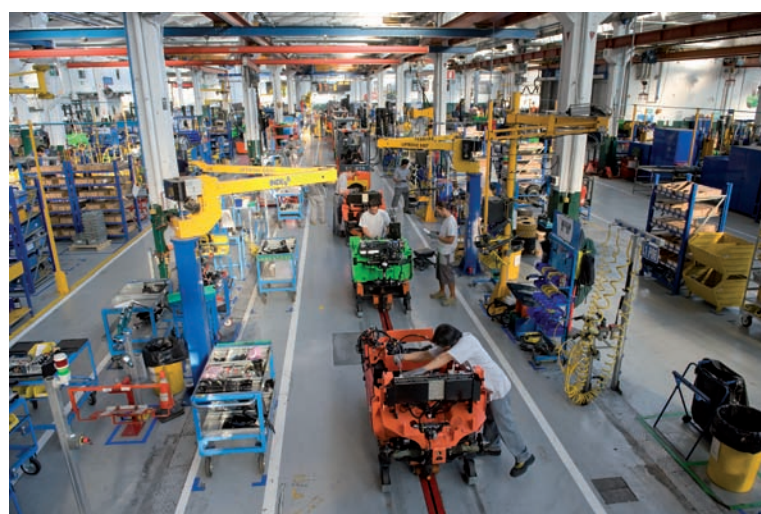
Particolare dello stabilimento Cesab dove, a partire dal 2001, sono stati introdotti i principi base del TPS. La produzione Cesab (14 modelli e 3 brand) si articola in due linee flessibili alimentate da componenti comuni (oltre 1.600 codici) gestiti secondo la logica kanban e da componenti specifici che vengono forniti a kitting
